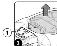
6. A serbatoio di recupero vuoto, ruotare il supporto coperchio serbatoio di recupero (2), il supporto opzionale è posizionato nella parte laterale sinistra dell'apparecchio (Fig.4).
