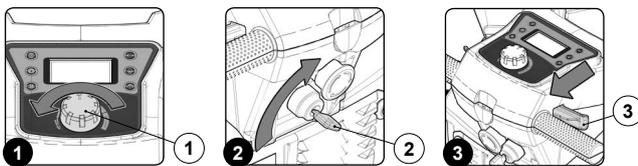
4. Regolare la velocità di avanzamento ruotando in senso orario il pomello (1), ruotarlo in modo graduale (Fig.4).
