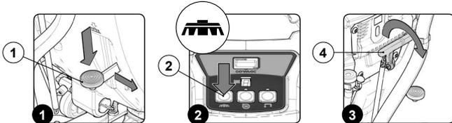
5. Attivando la leva presenza operatore (4) l'apparecchio inizia a muoversi (Fig.4).
