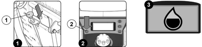
4. Premendo un'ulteriore volta il pulsante regolazione livello quantità acqua nel circuito impianto idrico (2) (Fig.2), si ha la possibilità di variare il livello.
