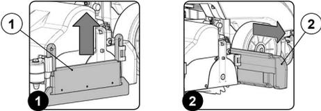
**NOTABENE:** Per effettuare quest'operazione utilizzare la maniglia costampata posizionata nella parte inferiore del cassetto di raccolta.
