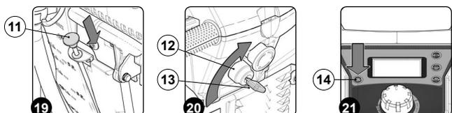
**i** **NOTABENE:** Impostare al massimo la quantità di acqua presente nel sistema di dosaggio, premendo il pulsante (14) fino a che il simbolo "REGOLAZIONE QUANTITÀ ACQUA" sia completamente riempito (Fig.22).
