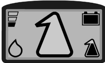
L'immagine qui a fianco identifica la "QUANTITÀ PERCENTUALE DETERGENTE A ZERO" nel circuito impianto idrico (versioni con sistema CDS).
