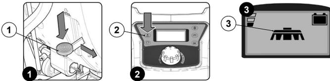
4. Abbassare il corpo tergipavimento andando ad agire sulla leva (4) posta nella parte posteriore dell'apparecchio (Fig.4).
