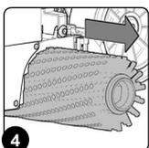
7. Pulire sotto un getto d'acqua la spazzola e rimuovere eventuali impurità presenti nelle setole. Verificare l'usura delle setole e in caso di consumo eccessivo sostituire la spazzola (la sporgenza delle setole non deve essere inferiore a 10 mm).
