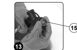
12. Pulire sotto un getto d'acqua la spazzola e rimuovere eventuali impurità presenti nelle setole. Verificare l'usura delle setole e in caso di consumo eccessivo sostituire la spazzola (la sporgenza delle setole non deve essere inferiore a 10 mm).
