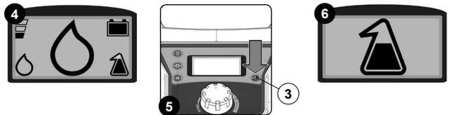
7. Premendo un'ulteriore volta il pulsante regolazione livello quantità acqua nel circuito impianto idrico (3) (Fig.5), si ha la possibilità di variare il livello.
