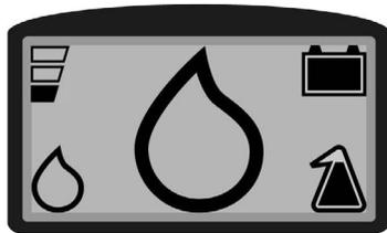
L'immagine qui a fianco identifica la "QUANTITÀ ACQUA A ZERO" nel circuito impianto idrico (versioni con sistema CDS).
