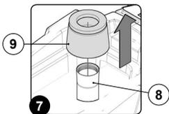
Per effettuare la pulizia del filtro-galleggiante serbatoio di recupero con la pistola spray, valido per le versioni con il sistema SST, eseguire quanto segue:
